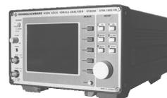
Der **VOR/ILS Analyzer EVS200** dient zur Überprüfung von terrestrischen Funknavigationseinrichtungen auf Flughäfen. Folgende Komponenten von ILS- und VOR-Systemen können geprüft werden:
