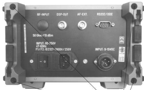
**1** Vier Schrauben lösen und Frontplatte abnehmen
